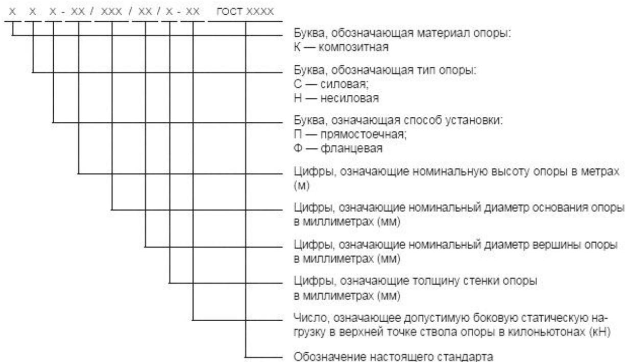
Рисунок 4.3 - Структурная схема маркировки композитных опор
