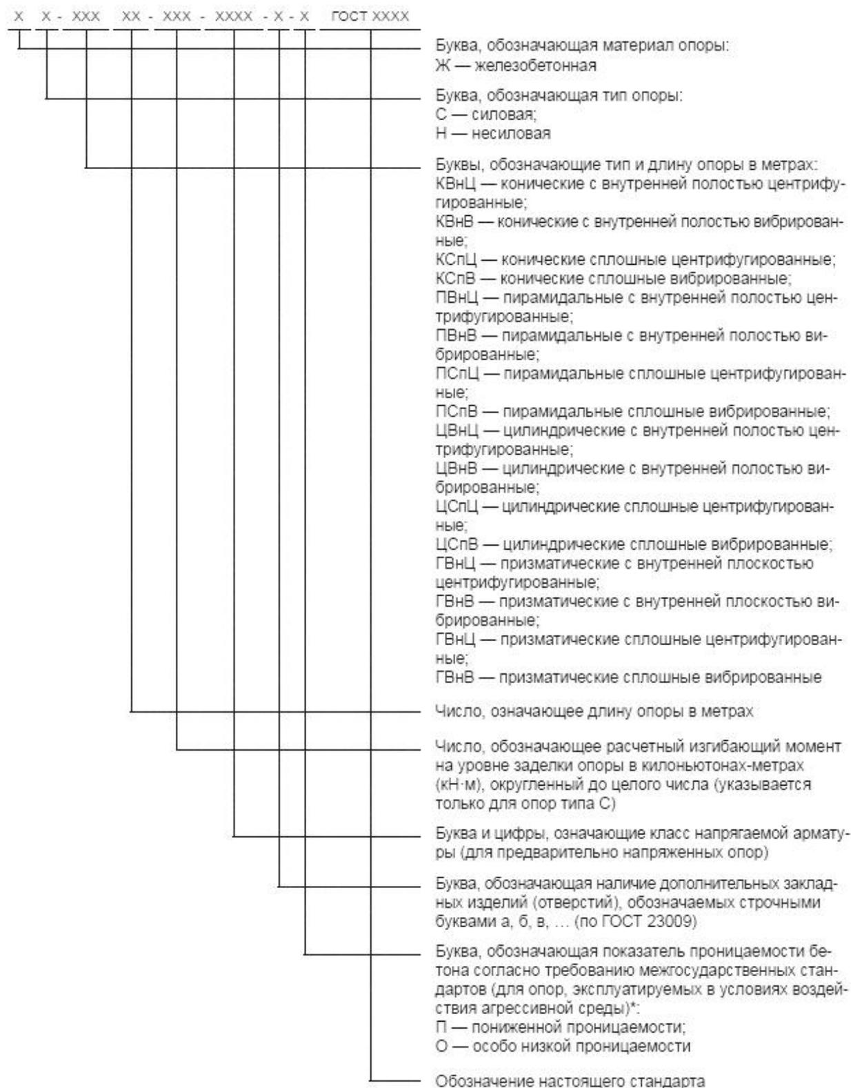
Рисунок 4.2 - Структурная схема маркировки железобетонных опор
