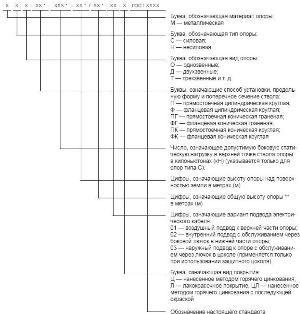
**Рисунок 4.1 - Структурная схема маркировки металлических опор**
